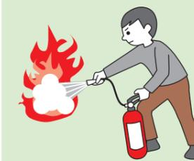
消火器は上部の安全栓を引き抜き、ホースの先を火元に向け、レバーを握ると、薬剤が出る。一般に射程距離は3~5m、噴射時間は10~15秒。狙いを定めてレバーを握る。
