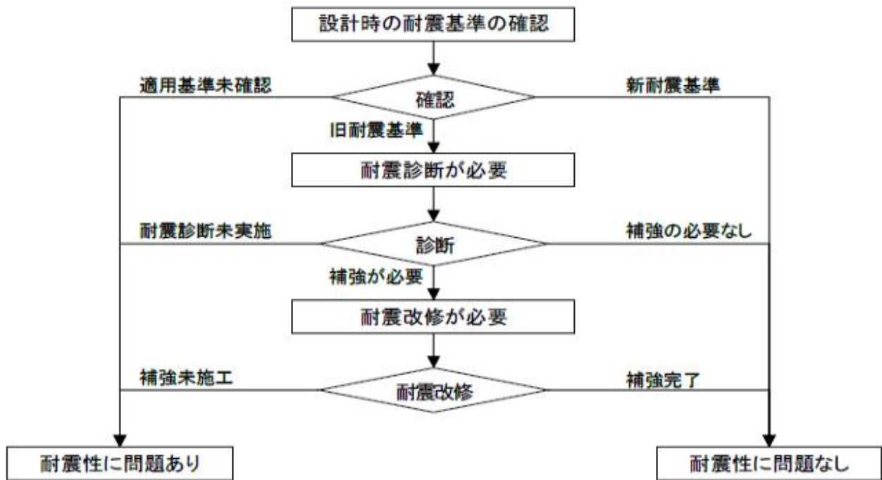
図 7 「耐震性」評価のフローチャート
