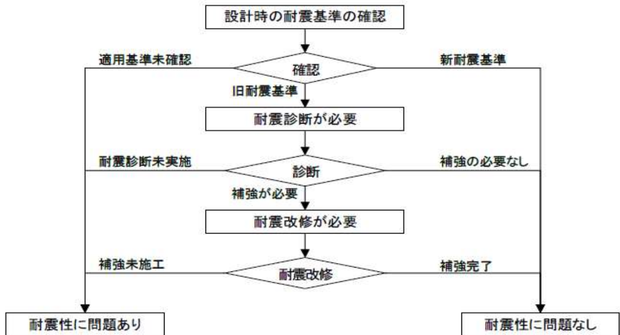
図 7 「耐震性」評価のフローチャート
