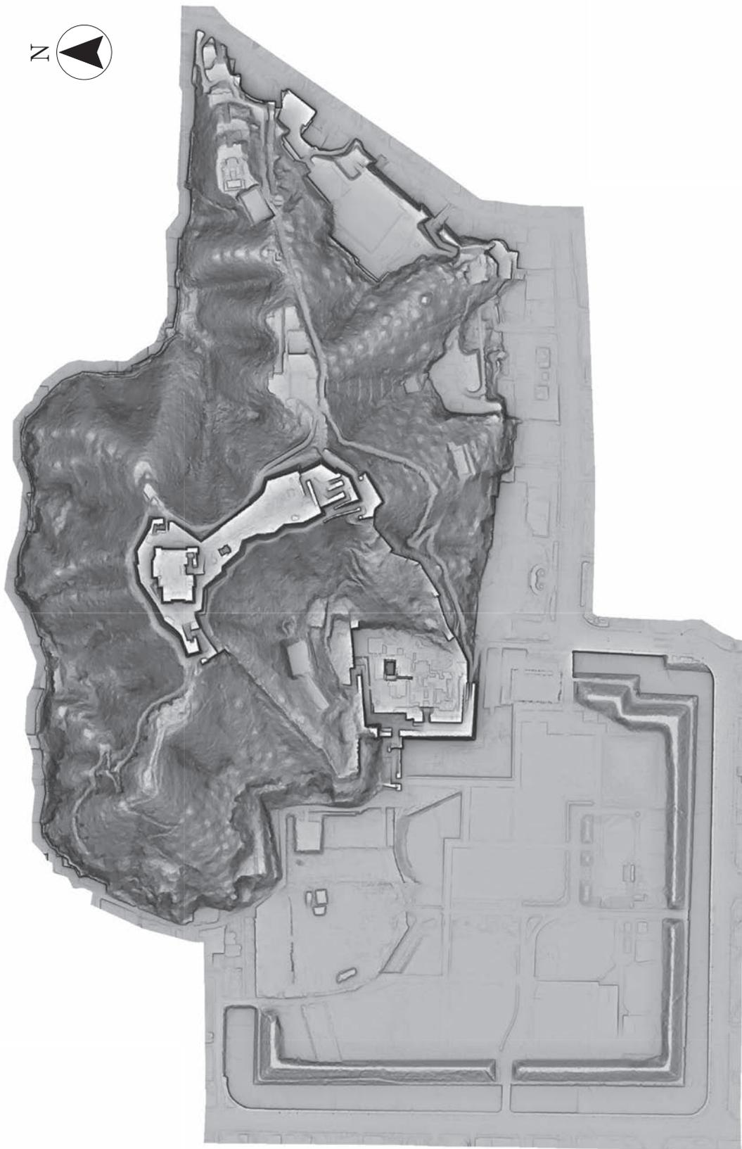
図16 松山城跡レーザー測量地形図
