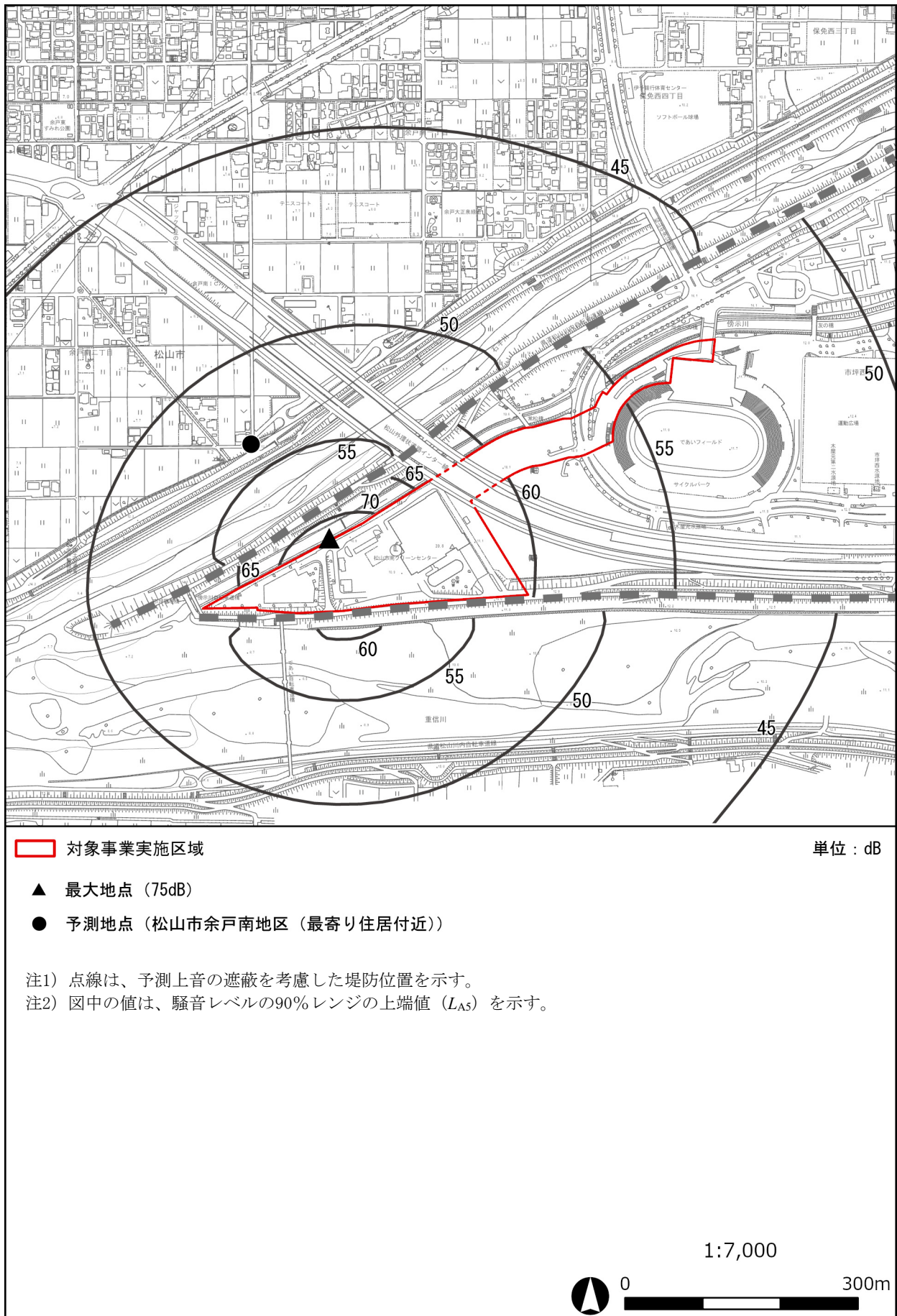
図 6.2-6(1) 建設機械の稼働に伴う騒音の予測結果 (新施設建設工事)
