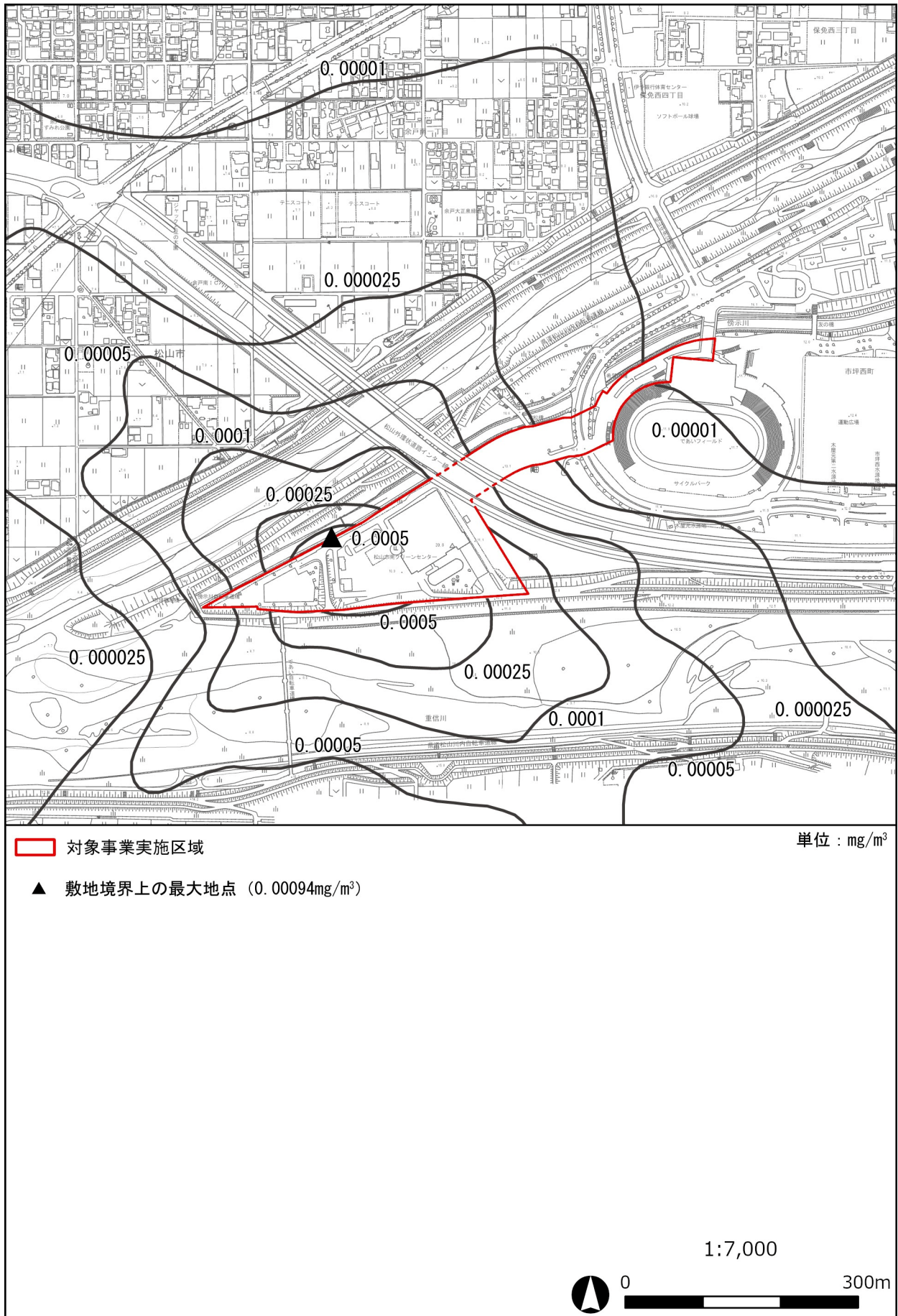
図 6.1-19(2) 建設機械の稼働に伴う浮遊粒子状物質の予測結果 (寄与濃度)
