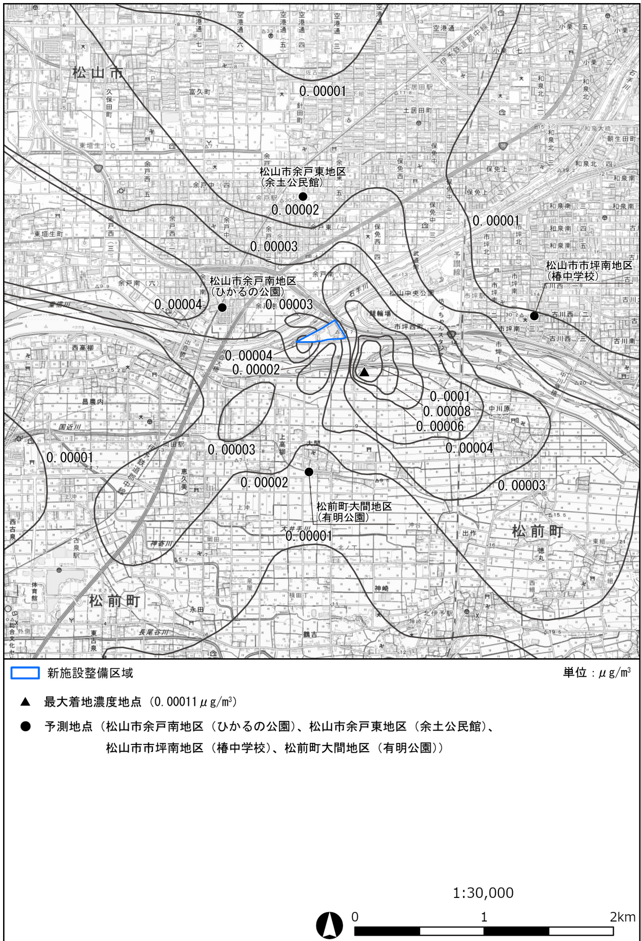
図 6.1-36(5) 施設の稼働に伴う水銀の予測結果 (寄与濃度：長期濃度 (年平均値))
