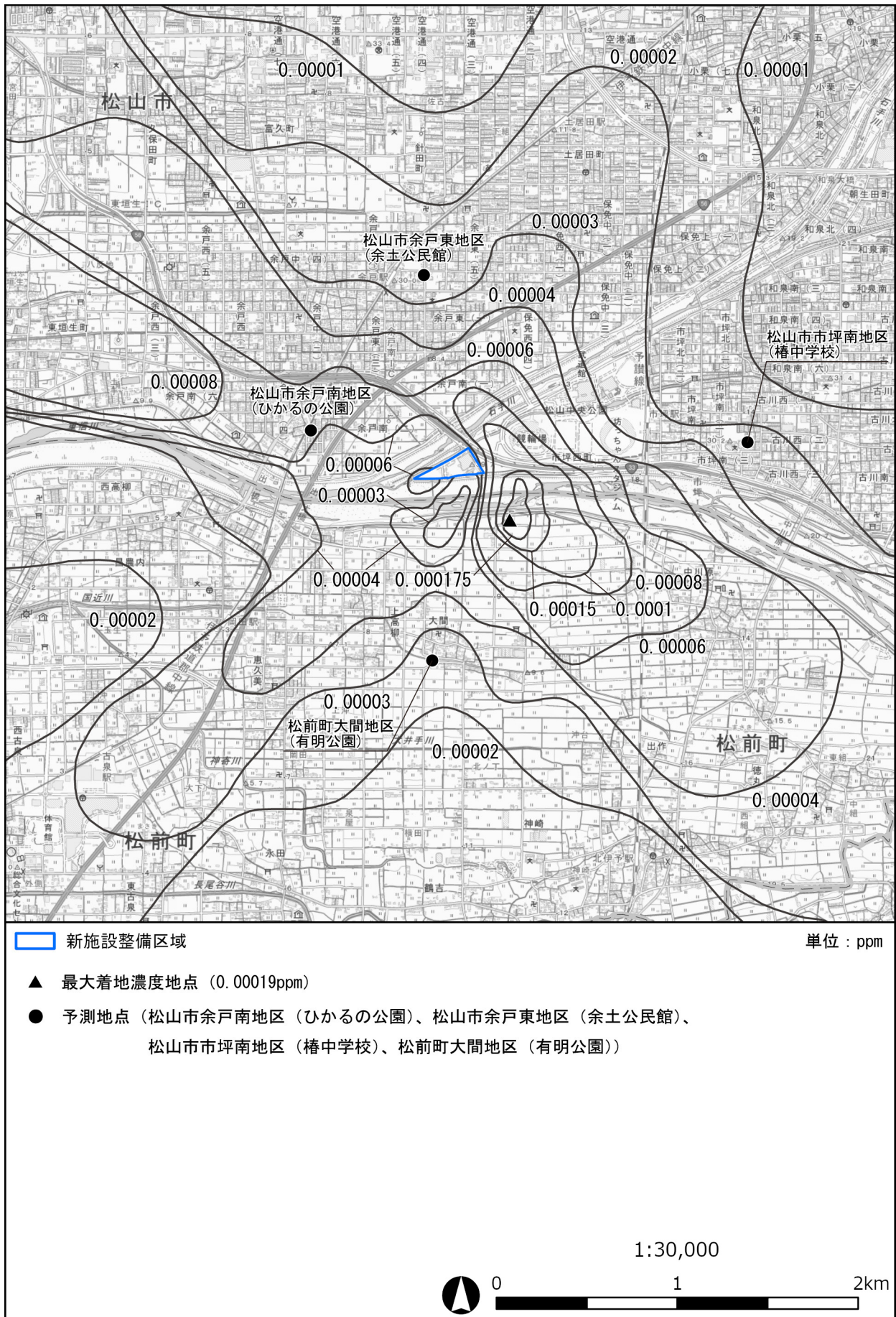
図 6.1-36(4) 施設の稼働に伴う塩化水素の予測結果 (寄与濃度 : 長期濃度 (年平均値))
