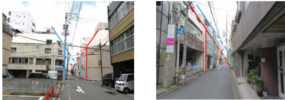
斜線制限により建物形態に影響を受けている例（L字地区内）
