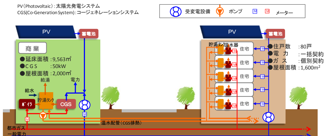
図 4-2 商業施設と集合住宅エリアのエネルギー共同利用モデルイメージ図
