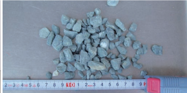
図 3-1-2 地元産骨材（青石）の利用
