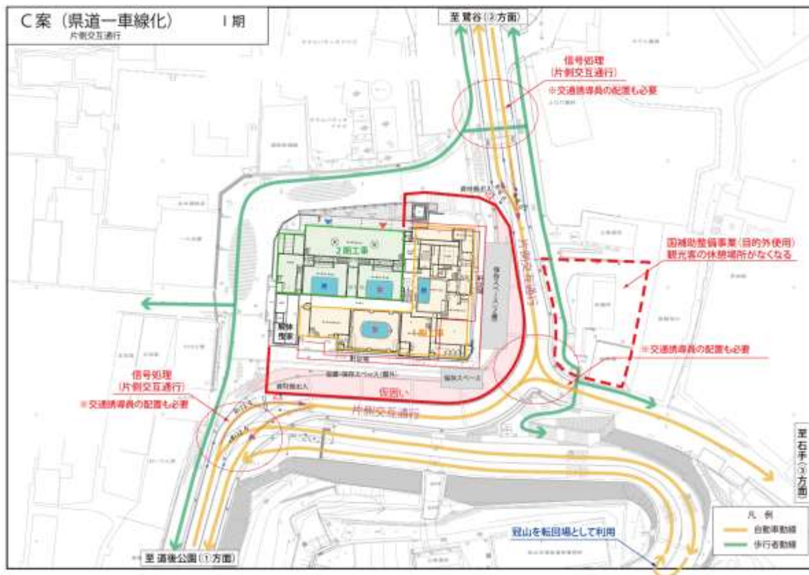
C案 (県道一車線化) I 期 片側交互通行
