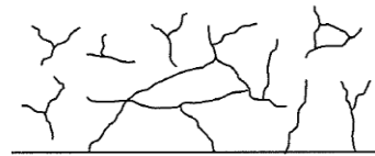
材料や練混ぜの不備に起因する収縮ひび割れ
