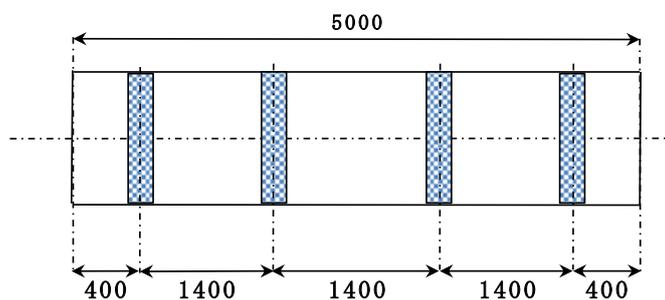
(2) 直管  $\phi 75$  mm ~  $\phi 100$  mm
