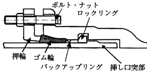
図-13-28-3 異形管の継手構造 (φ 500 mm～φ 1000 mm)
