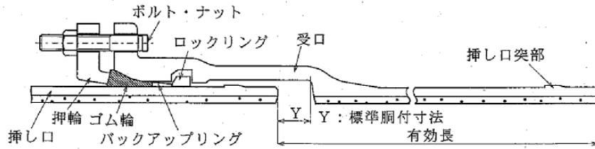
図-13-28-2 NS形直管 (φ 500 mm～φ 1000 mm)
