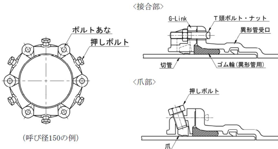
図-13-28-7 G-Link を使用した継手構造
