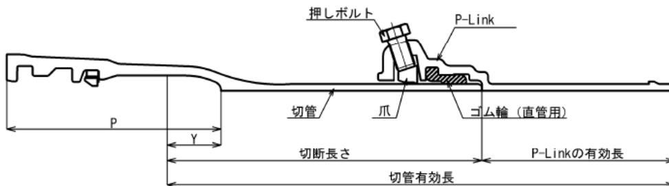
図-13-28-6 P-Link を使用した継手構造
