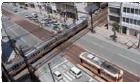
どちらも伊予鉄道。ダイヤモンドクロスでは郊外電車が優先。路面電車は自動車と同じように信号待ちをして通過を待つ。
