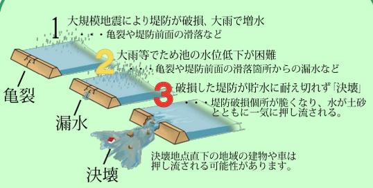
緊急時には、ため池の水位を低下させるなど、決壊を防ぐための処置が行われます。
