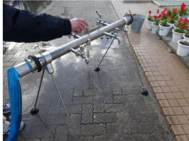
応急給水栓を閉めたら必ず仮設給水栓を開けて閉の確認をしてください。
