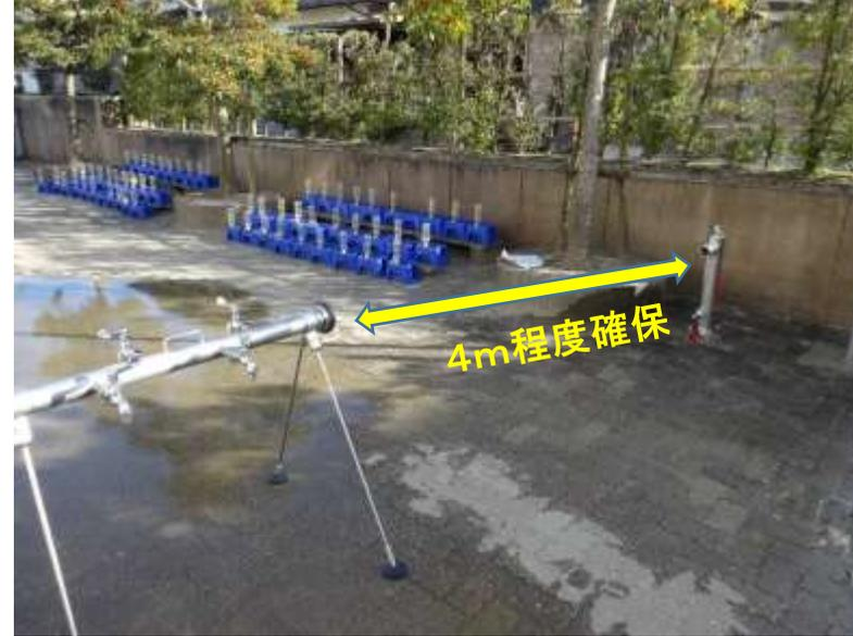
ホースの長さが5mになっています。適度な距離を確保してください。(4m程度)
