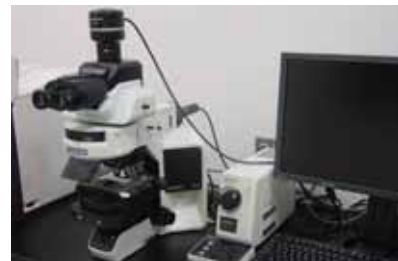
落射蛍光顕微鏡 (クリプトスポリジウムなどを検査します)
