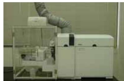
誘導結合プラズマ質量分析計 (カドミウムなどの金属類を検査します)
