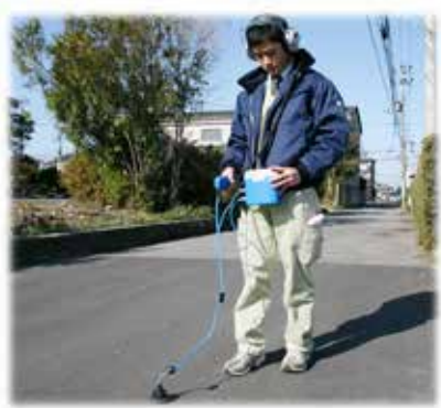
市内全ての水道管の水漏れを調べています。
