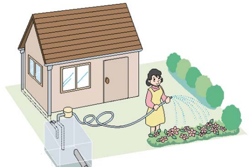
浄化槽の雨水貯留槽転用
