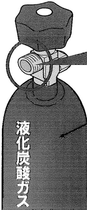
事故の背景には、酸素ポンベと同じ接続口 (口径、ネジ部が同じ) の **工業用液化炭酸ガスポンベ** を院内で採用していたことが確認されています。
