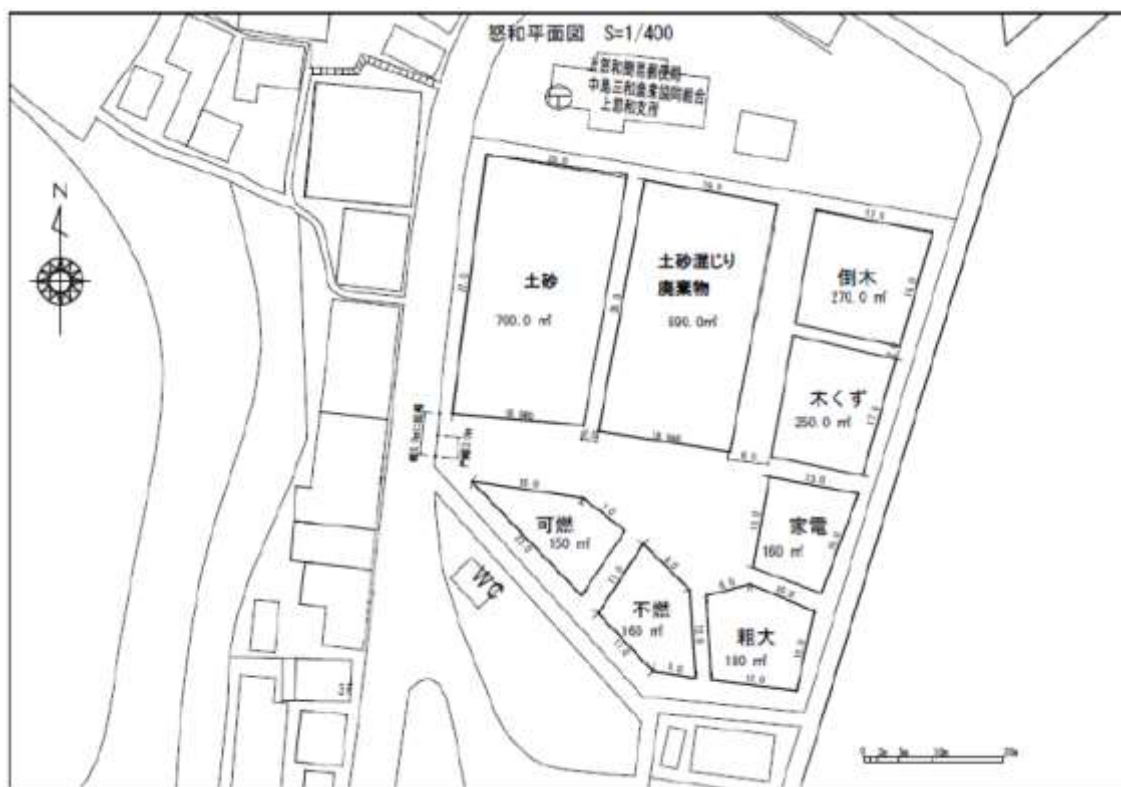
図 2-12-(1)-2 土砂混じりがれきを含む仮置場のレイアウト例
