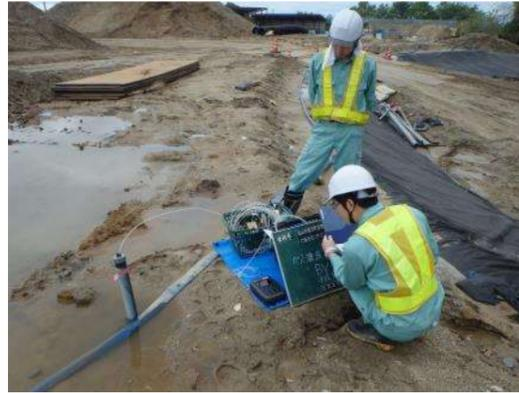
写真-2 孔内ガス測定状況
