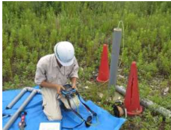
写真2 孔内ガス測定状況の例
