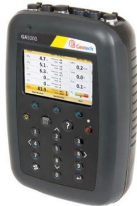
写真2-1 携帯型ガス測定器
