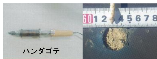
図6 シートの穴開け装置と穴開け状況
