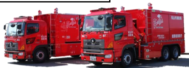
海水利用型消防水利システム
