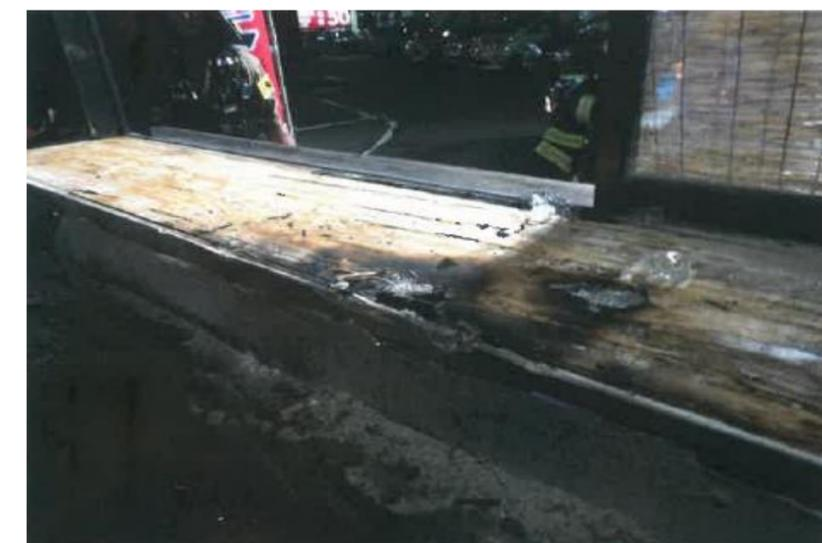
ステンレス板内部の焼損
