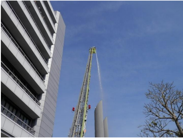
梯子車からの梯上放水
