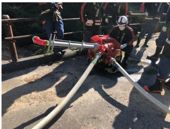
中継ポンプ設定状況
