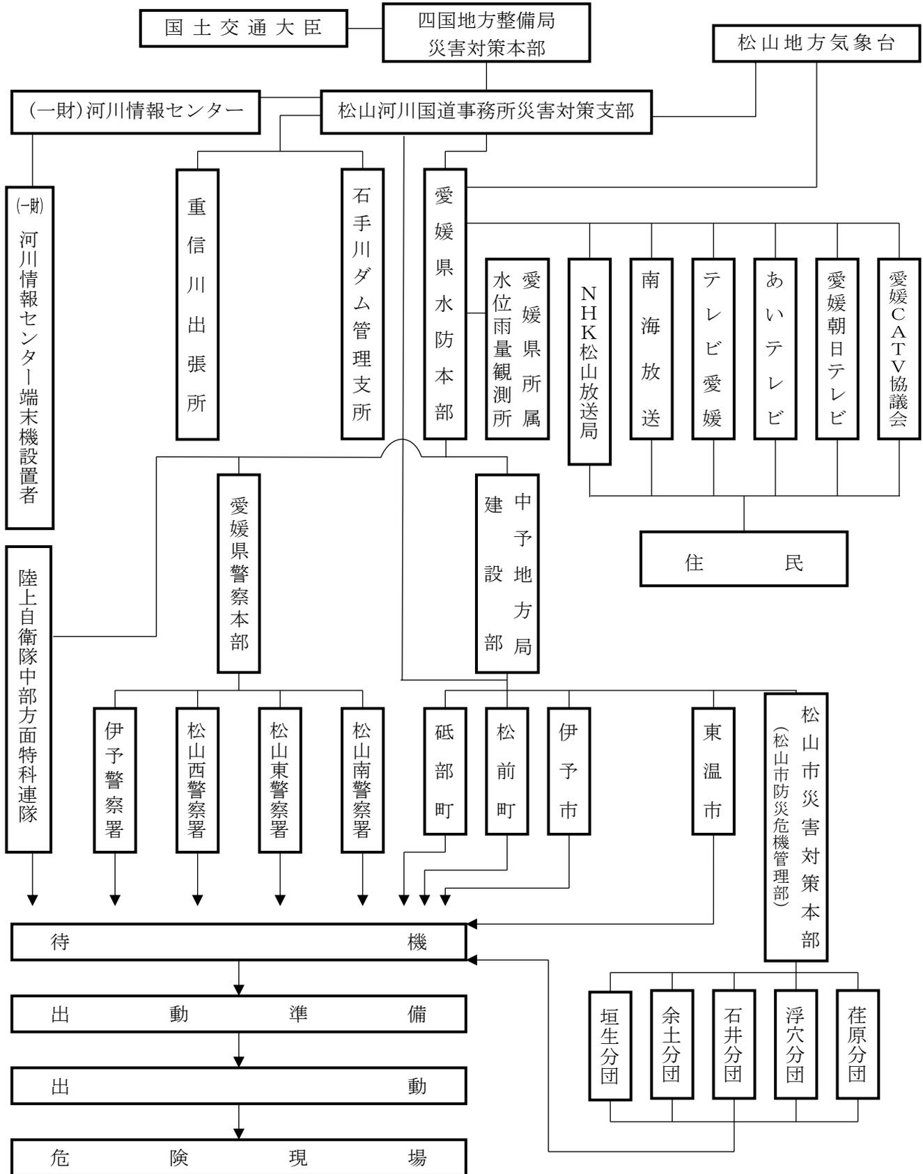
(2) 国土交通省四国地方整備局松山河川国道事務所の行う石手川の水防警報伝達系統図(石手川:湯渡水位観測所)
