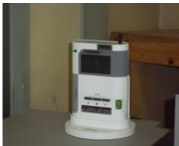
緊急地震速報受信装置
