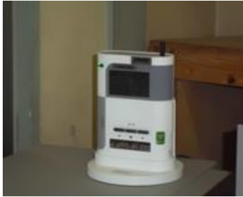
緊急地震速報受信装置
