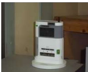
緊急地震速報受信装置
