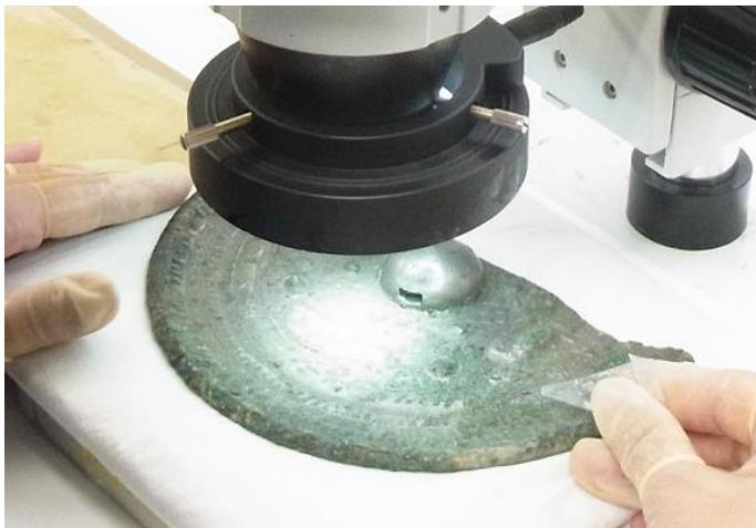
銅鏡は表面の剥離の恐れのある箇所は、アクリル樹脂 40%酢酸エチル溶液を用いて充填。
