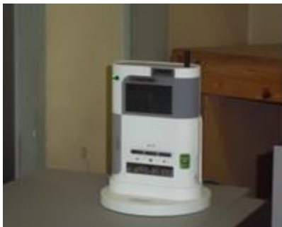
緊急地震速報受信装置（平成24年4月より運用開始）
