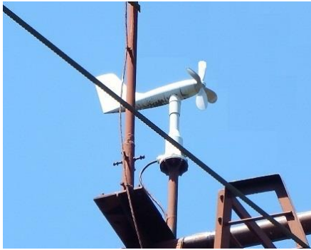
ロープウェイ支柱に設置した風速計
