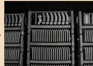
焼きあがった瓦は1枚1枚打音検査を行い、中に空洞や損傷が無いことを丁寧に確認したのち、合格したものが道後温泉本館の南棟(棧瓦葺)に葺かれます。
