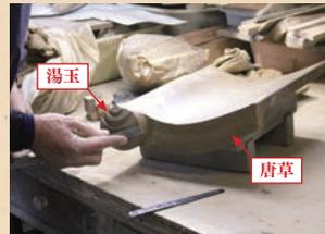
成形した湯玉の部分と唐草部分を熟練した職人の手で取り付けます。瓦の表面に光沢を良くするため加工を施し、5日ほど陰干します。
