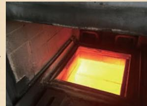
乾燥した瓦は1,050℃のガス窯で焼き上げられ、約20時間密閉し、いぶされます。この時に菊間瓦特有のいぶし銀色の光沢ができます。
