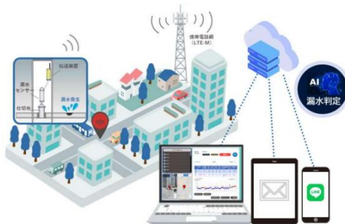
漏水探知法による面的な漏水調査 出典：「DXを用いた漏水調査等のスクリーニング技術についての導入の手引き」 (令和7(2025)年6月、国土交通省)
