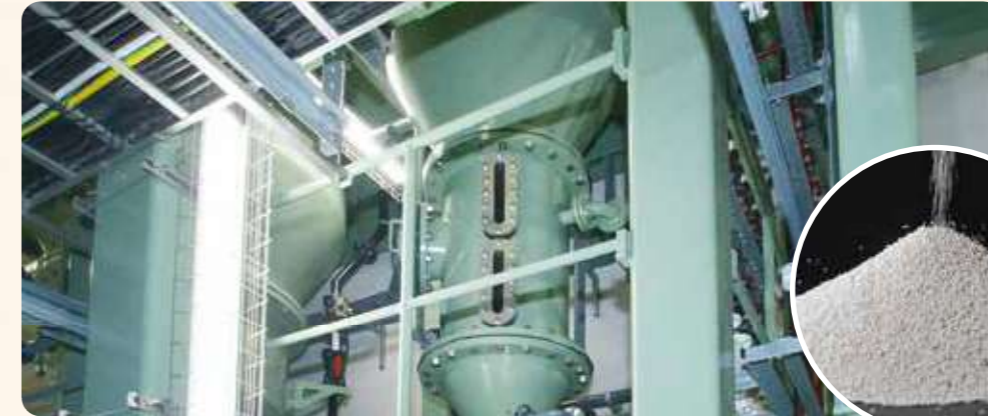
MAP反応塔 濃縮分離液に薬品を加え、リンとアンモニア、マグネシウムを含んだ結晶を作る装置です。
