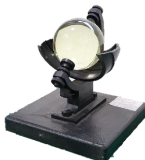
明治時代の気象観測器 (日照計) (気象庁気象測器検定試験センター所蔵)
