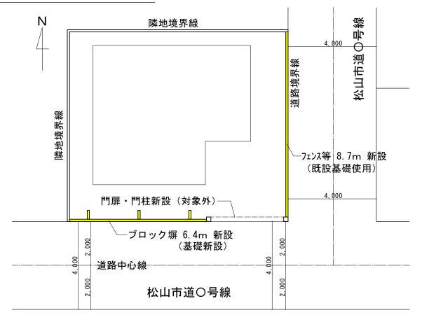
※ フェンス等が面する道路の種別と幅員、道路境界線、新設するフェンス等の 種類・位置・延長及び基礎新設の有無を図示すること。
