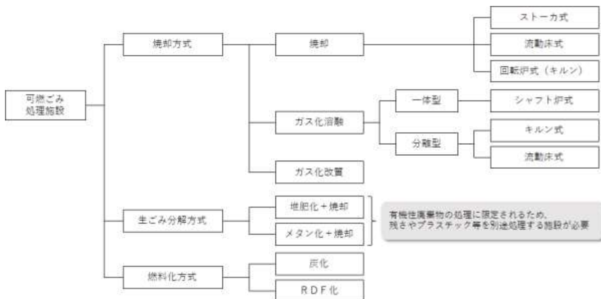
図 5-2 可燃ごみの処理方式
