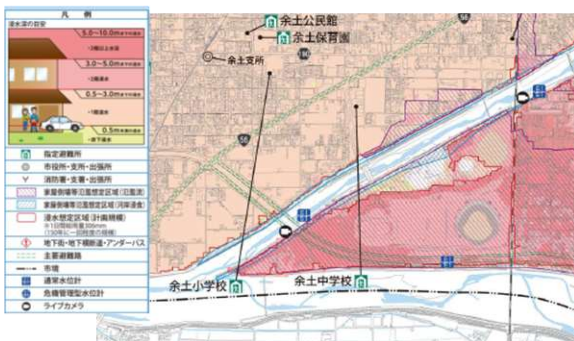
出典：まつやま洪水ハザードマップ石手川版 松山市防災・危機管理課 図 7-11 建設予定地周辺の浸水想定図
