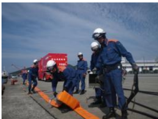
水中ポンプからのホースとホース延長車のホースとを金具で結合する
