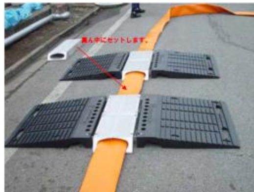
他の車両が通過する場所にはホースブリッジを設定する（耐荷重 5t、50km/h まで）
