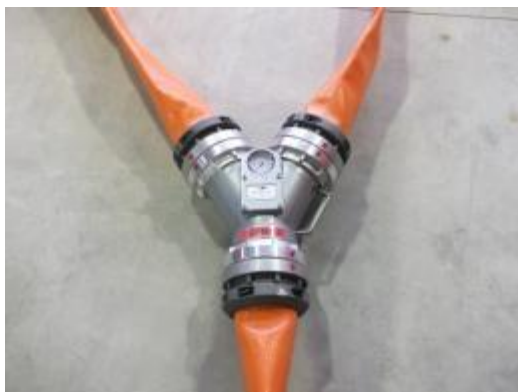
二又分岐金具により 150mmホースの2線延長も可能
