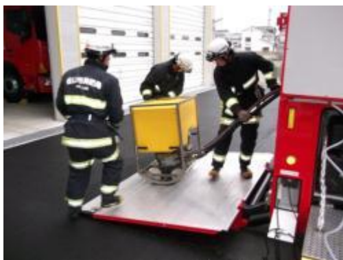
水中ポンプを車両から降ろす
