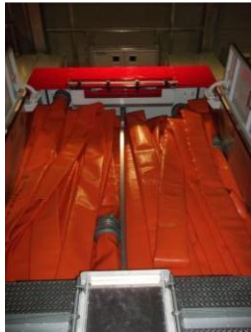
コンテナ内のホース収納状況
