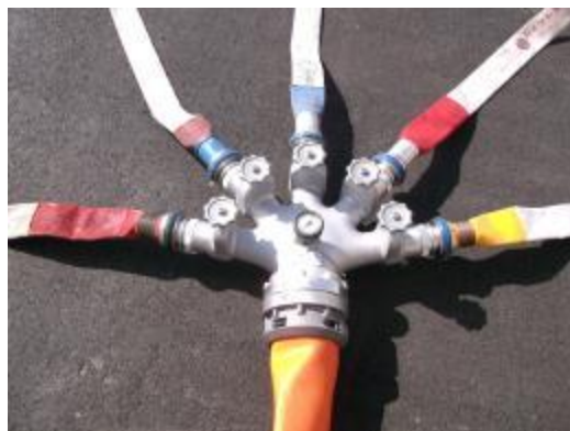
延長先に多分岐金具を設定し 65mmホースに水を分配可能
