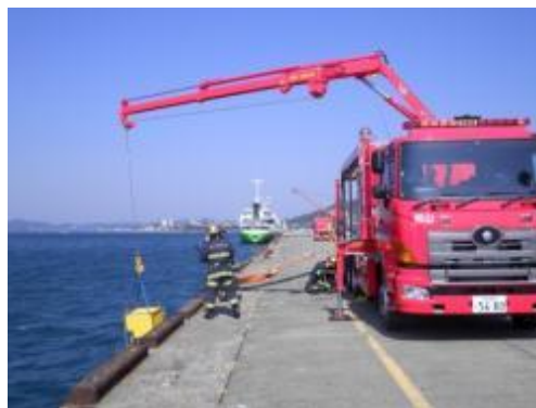
水中ポンプを投入する
