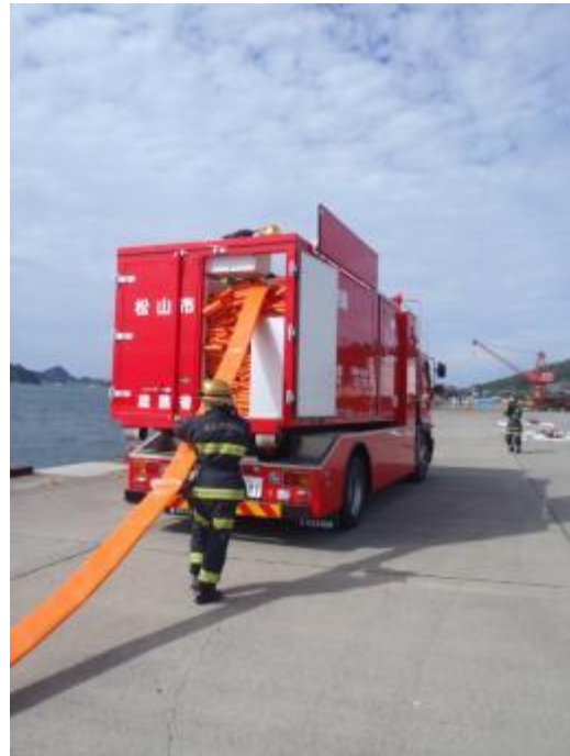
車両が走行しながらホースを延長する
