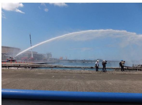
17 大容量泡放射システム放水状況
