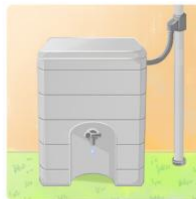
雨水貯留施設（雨水タンク）
